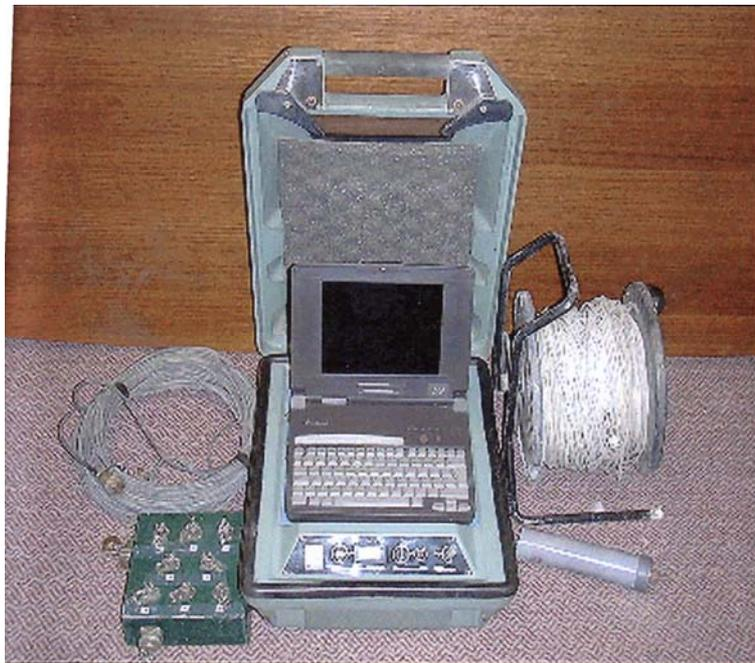
Fotografía III.1; "Sistema Blastronics BMX".
