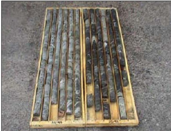
Foto 4.1: "Pórfido Andesítico en color claro y Brecha Ígnea de Pórfido Diorítico en color oscuro"
