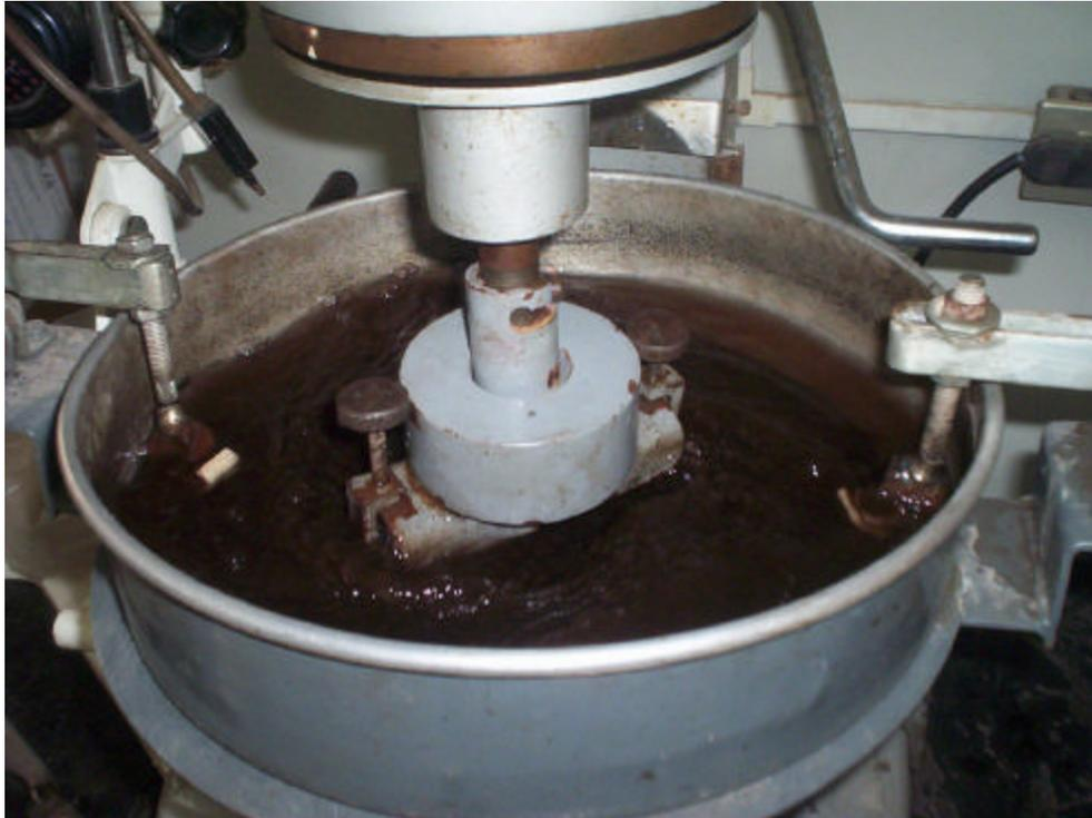
**Figura 10 Ensaye de abrasión**
