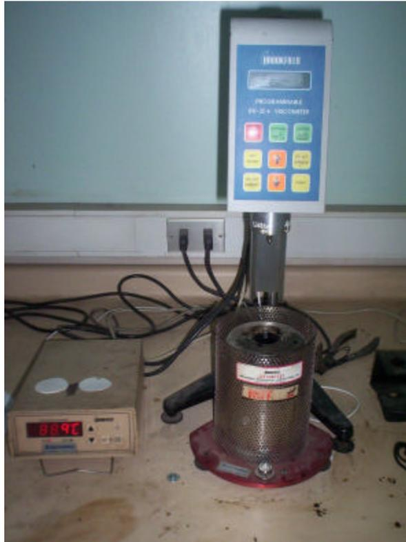
Figura 6 Viscosímetro rotacional Brookfield
