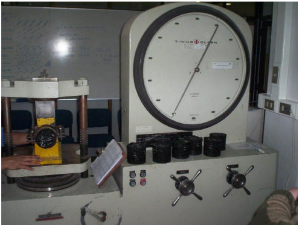
**Figura 9** Ensayo de corte
