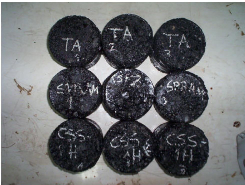
**Figura 31 Probetas Marshall para ensaye de Corte**
