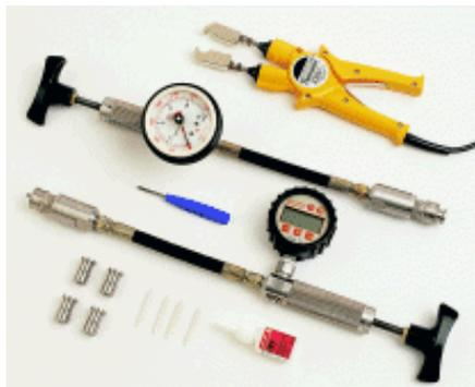
**Figura 8 Equipo medidor de adhesividad**
