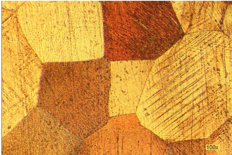
Figura 4.87: Probeta de 200  $\mu\text{m}$  ensayada cíclicamente a 2.2% deformación a temperaturas: 6, 25, 50, 6, 25, 50  $^{\circ}\text{C}$
