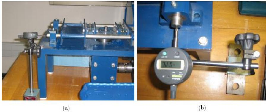
Figura 3.8: Dial mecánico: a) forma en que va montado; b) vista superior.
