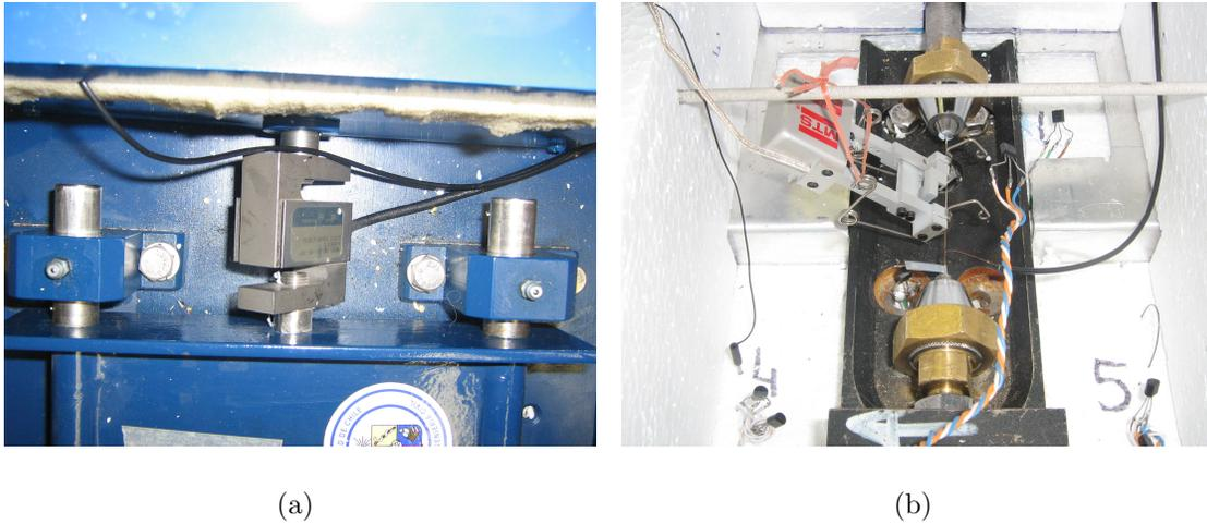
Figura 3.11: Sensores de medición: a) celda de carga; b) extensómetro.
