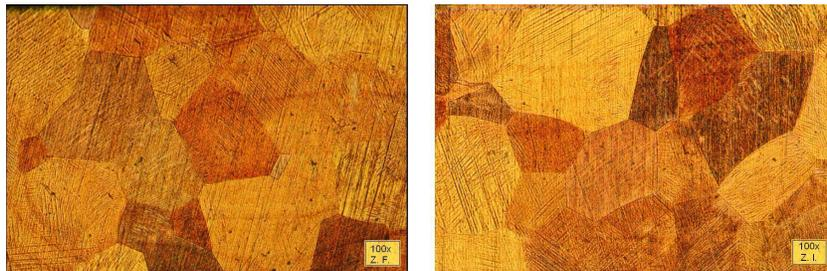
Figura 4.85: Probeta de 115  $\mu\text{m}$  ensayada en tracción a 50 °C, serie 2
