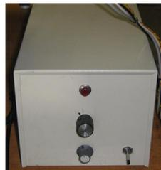
Figura 3.5: Fuente DC de voltaje variable.
