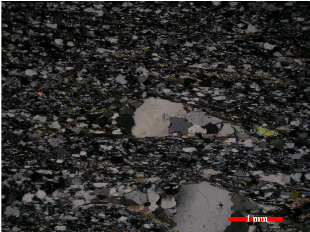
Figura 66: microfotografía de cola sigma en porfiroclasto de feldespato potásico. Indica movimiento dextral. Muestra GAR18 A.
