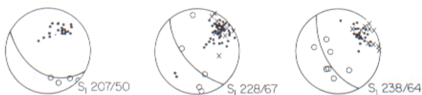
Figura 31: estereogramas para las estructuras D1 en Bahía Pía, ordenados de izquierda a derecha corresponden a norte, centro y sur. Los círculos negros representan polos S1, los blancos L1 y las cruces polos S1 en diques. Tomada de Nelson et al. , 1980.
