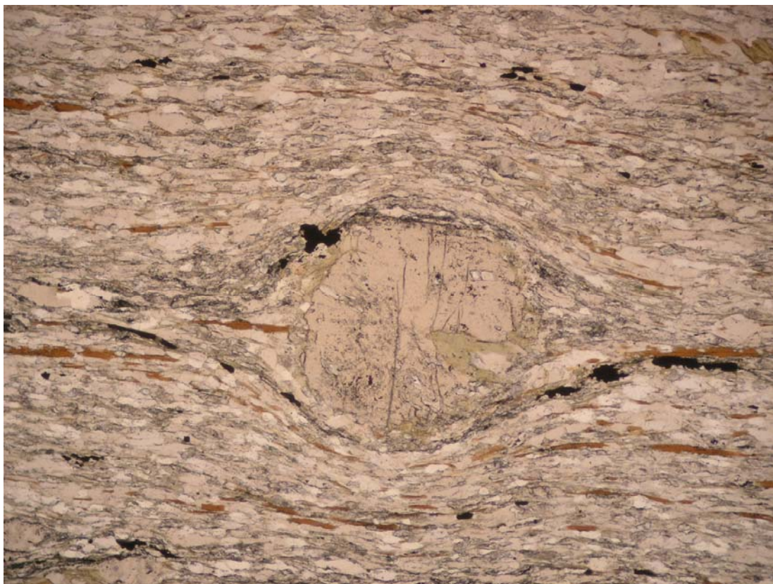
Figura 56: microfotografía de la mineralogía presente: cuarzo, biotita y granate. Además este grano de granate se encuentra reemplazado parcialmente por clorita. Esto evidencia metamorfismo retrógrado. Esta fotografía corresponde a la Unidad Metasedimentaria. Muestra GAR23.
