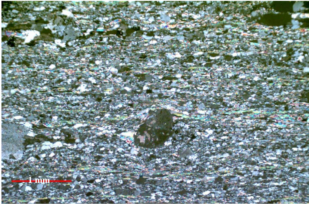
Figura 65: microfotografía que muestra sombras strain tipo sigma en porfiroclasto de feldespato. Indica movimiento dextral. Muestra GAR18 A.
