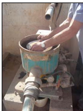
Figura IV.10 Concentrador Knelson, Planta “El Cateador”
