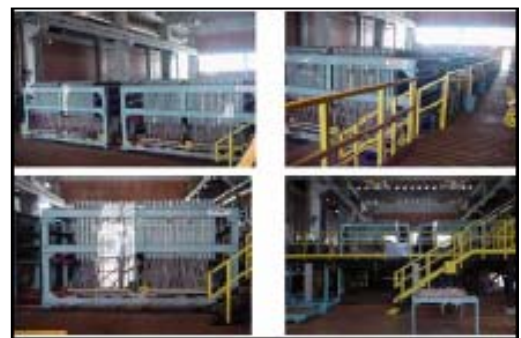
Fotografía D.2. Unidad electrolítica, Célula de Membrana, Planta Cloro-Soda, Brasil
