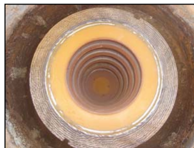
Figura IV.10 Concentrador Knelson, Planta “El Cateador”
