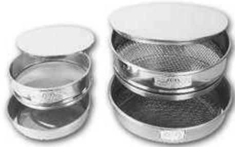
Figura 4-2 Tamices para medir la granulometría
