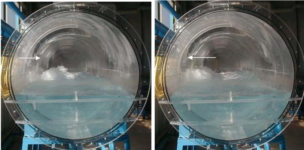
(a) Splashing: vista desde CE. (b) Zona de decantación baño quieto: vista desde CE.
