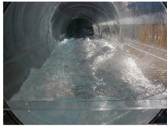
(d) Zona de reacción: splashing.
