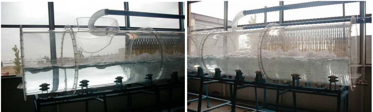
(a) Vista desde barriga: zona de decantación.
