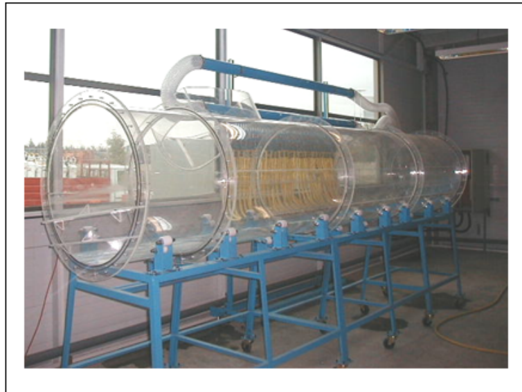
Figura 3.13: Maqueta a escala 1:5 del CT 2 de Fundición de Codelco Norte.
