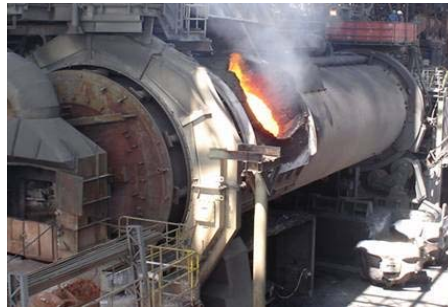
Figura 2.3: Zona de la boca en el Convertidor Teniente.
