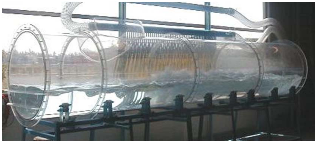
Figura 3.19: Resultados obtenidos por Cruz & Lara (2004) [3] para un nivel de llenado de 300 [mm].
