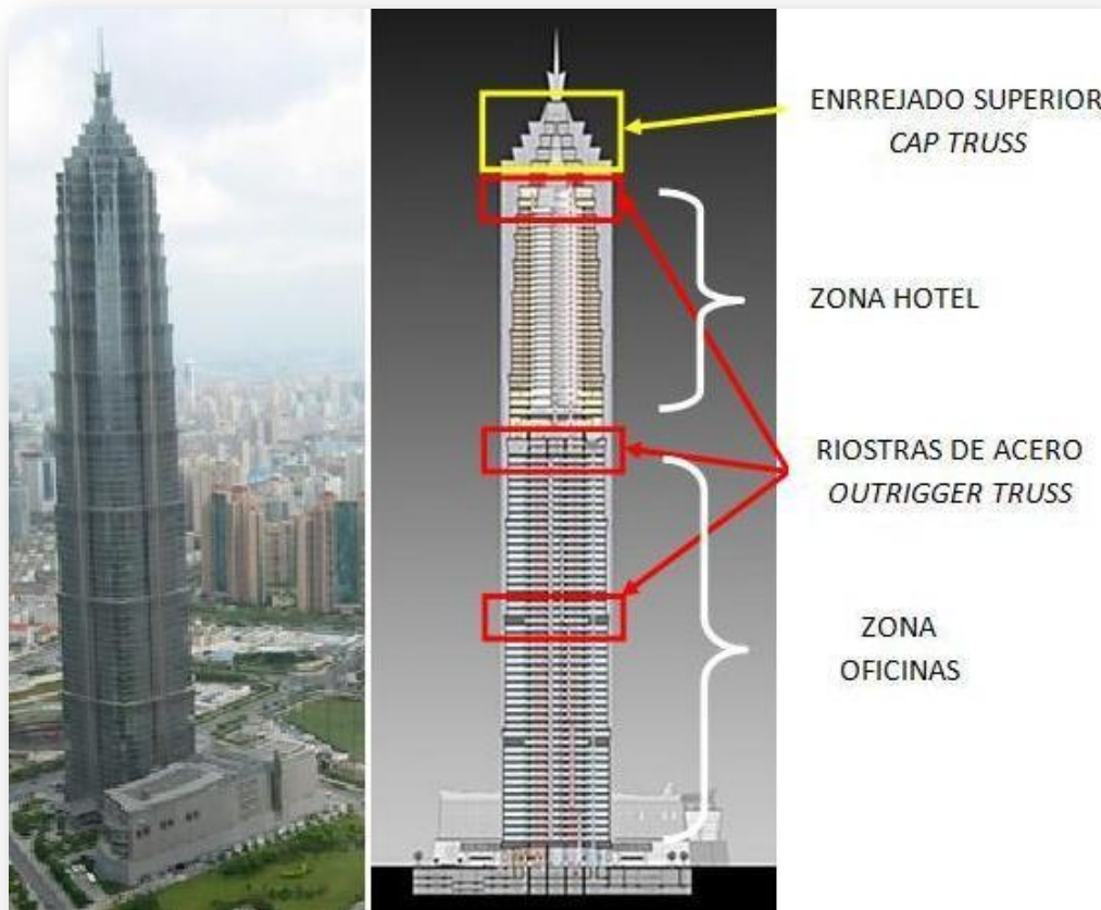
Figura 6. Sección de la Torre Jin Mao.
