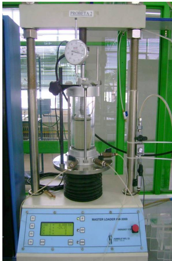
**Fig.3. 1: Equipo Triaxial Estático.**
