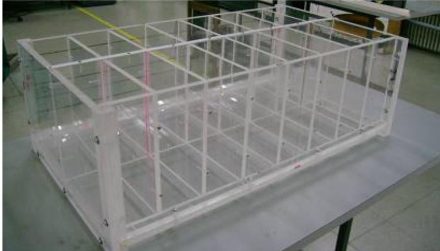
**Fig.4. 4: Caja Acrílica: Para envejecer probetas de arena de relave.**
