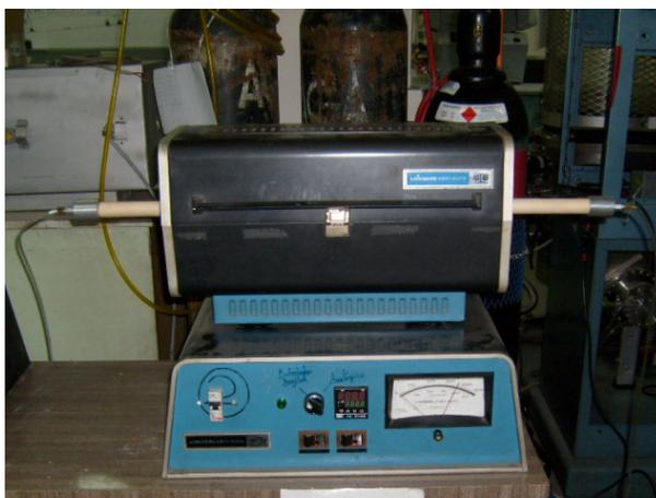
**Figura 3.3:** fotografía del montaje experimental para sinterización.
