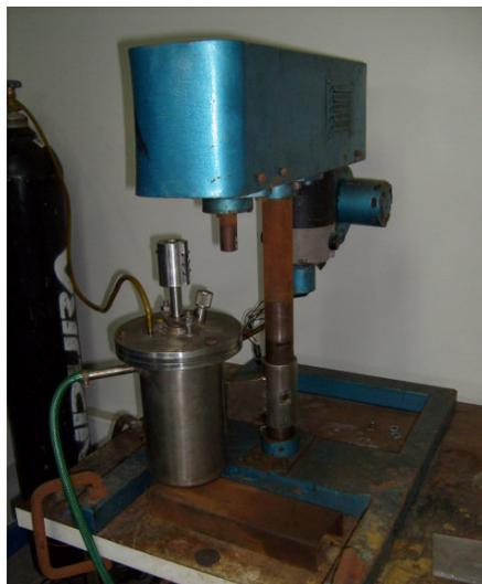
**Figura 3.1:** molino atritor utilizado para molienda reactiva.
