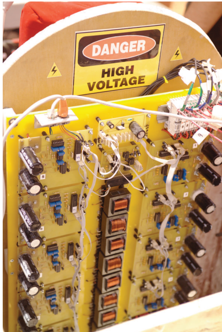
Figura 4.8: MPPT del auto solar Eolian.
