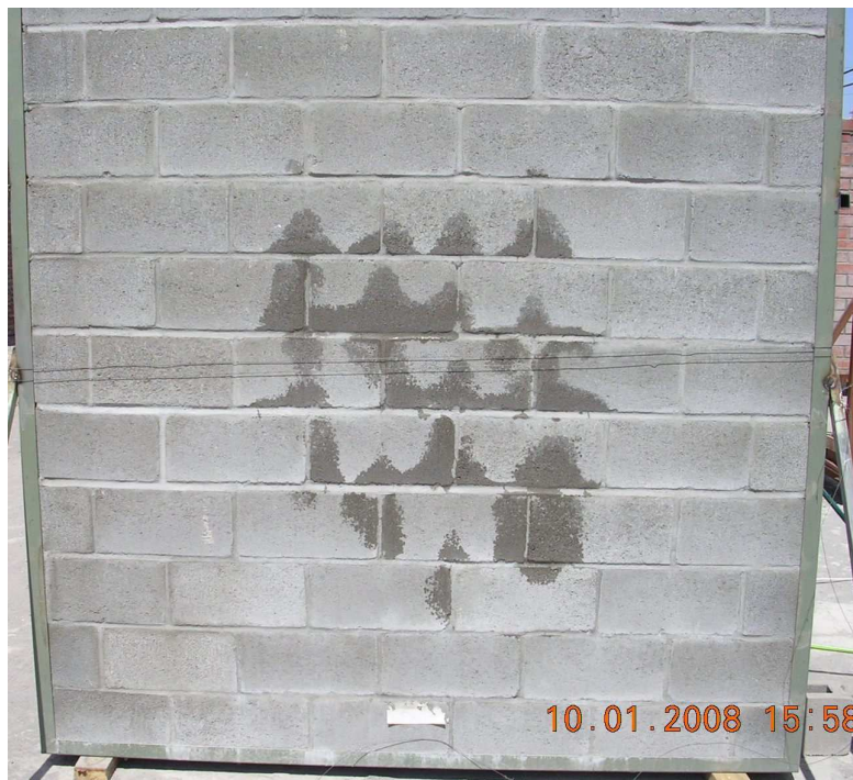
Fig. 6.2.4 Cara opuesta a la cámara en Muro 4 luego de 11 min de ensayo.
