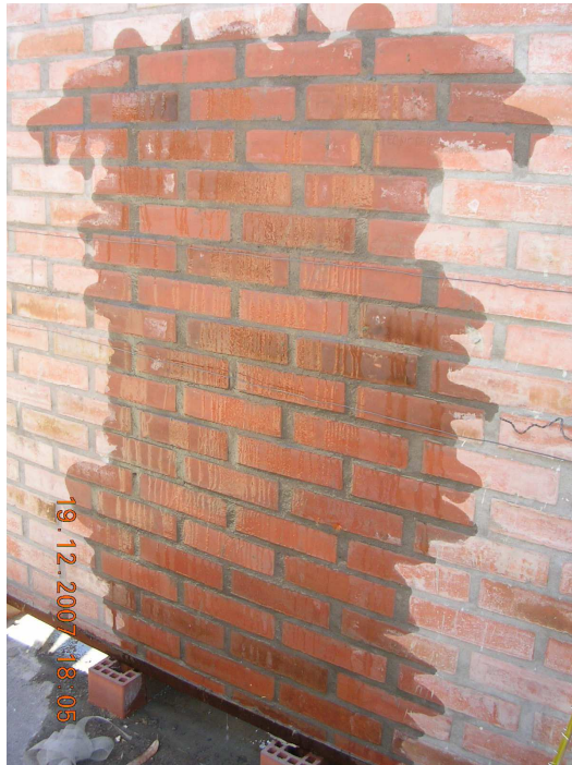
Fotografía 1.3: Muro 1 a 90 min de inicio de ensayo.
