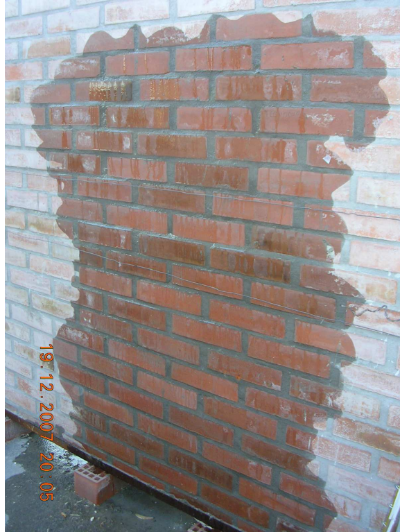
Fotografía 1.7: Muro 1 a 210 min de inicio de ensayo.
