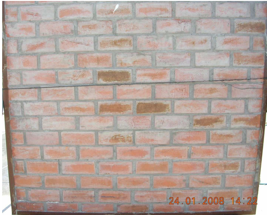
Fotografía 5.3: Muro 5 a 90 min de inicio de ensayo.
