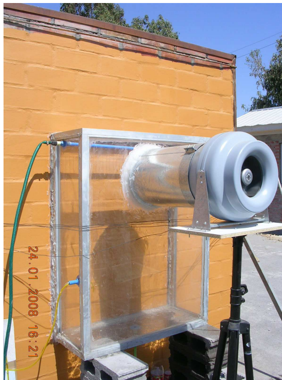
Fig.5.5.1 – Cara expuesta al ensayo Muro 5
