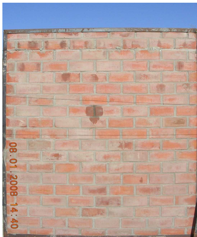
Fig. 6.2.3 Cara opuesta a la cámara luego de 4 h de ensayo en Muro 3
