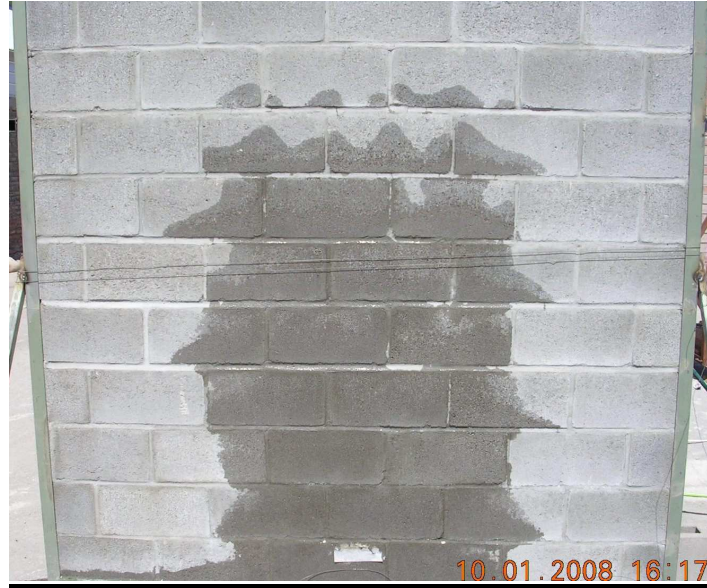
Fotografía 4.1: Muro 4 a 30 min de inicio de ensayo.
