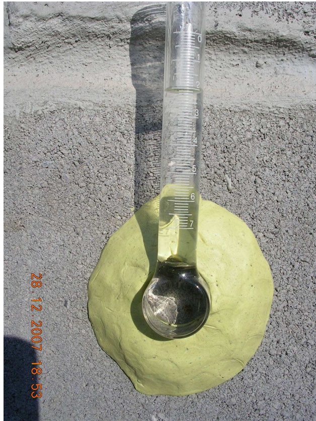
Fig.3.2.2 – Pipeta en un bloque de hormigón
