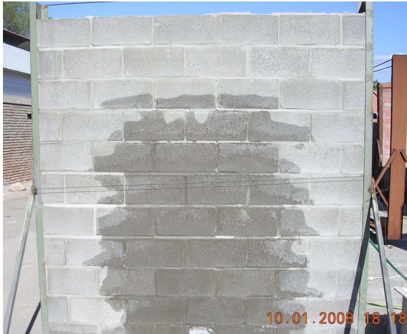
Fotografía 4.5: Muro 4 a 150 min de inicio de ensayo.
