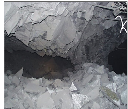
Figura 2-10: Ejemplo de pilar remanente en la mina Esmeralda (Brown, 2007)
