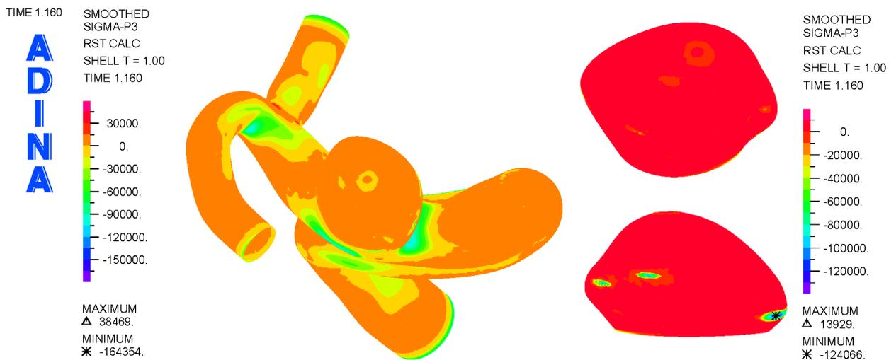
Figura 4.70: Simulación 7. Distribución del tercer esfuerzo principal en la pared arterial para la sístole (1.16 [s], segundo pulso).
