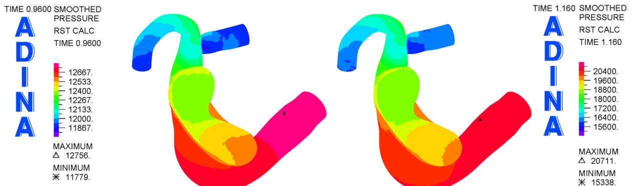
Figura 4.38: Simulación 4. Distribución de presión en la geometría completa para la diástole (figura izquierda. 0.96 [s]) y la sístole (figura derecha. 1.16 [s]).
