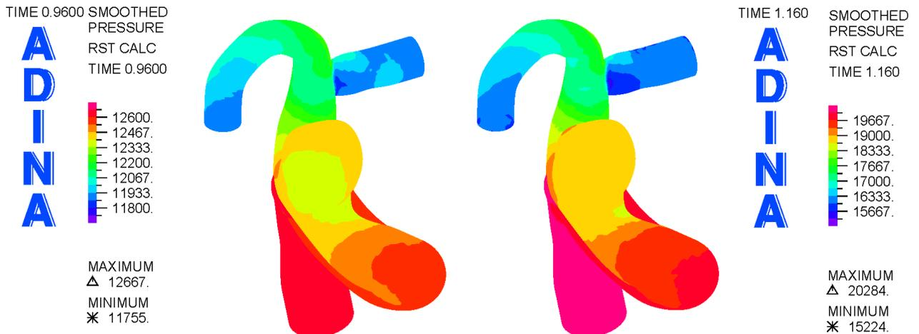
Figura 4.47: Simulación 5. Distribución de presión en la geometría completa para la diástole (figura izquierda. 0.96 [s]) y la sístole (figura derecha. 1.16 [s]).
