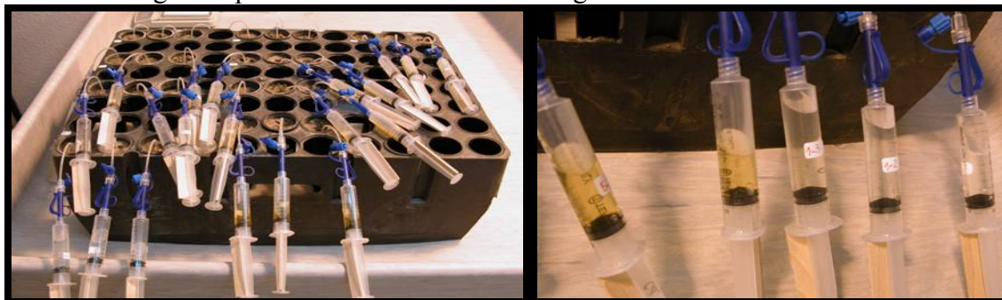
Figura 4: Obtención de agua de poro desde los sustratos experimentales. Los muestreadores cerámicos de agua de poro no son visibles en la imagen.
