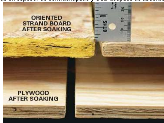
Figura 4: Diferencias en espesor de contrachapado y OSB después de absorber agua.
