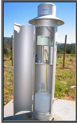
Figura 7. Pluviógrafo.
