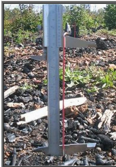
Figura 6. Medición de clavos de erosión.
