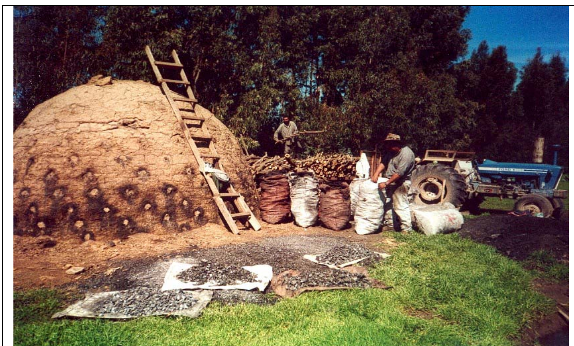
Figura 20. Etapa de descarga y ensacado del producto.
