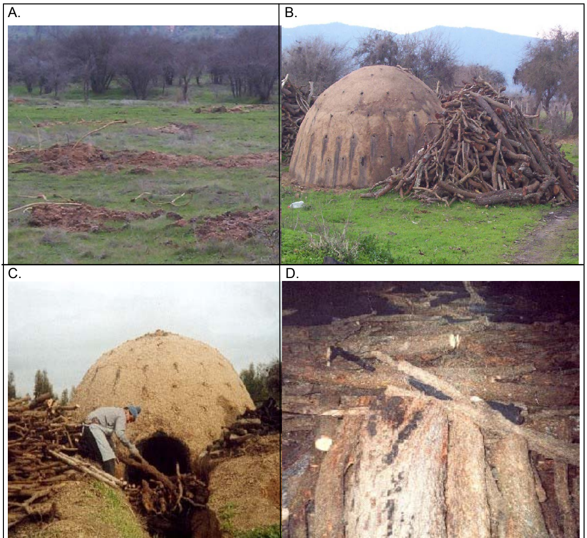
Figura 18. Subetapas de la extracción del recurso arbóreo para la producción de carbón de espio. A. Descegado. B. Acopio y secado de la leña. C. Cargado del horno. D. Carga dentro del horno.
