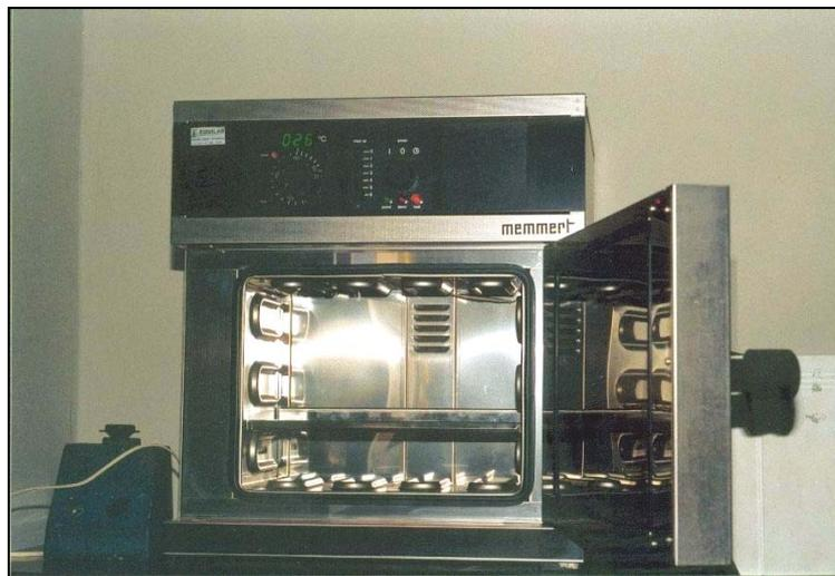
Figura 4 – 2: Horno digital MEMMERT, precisión 1°C.
