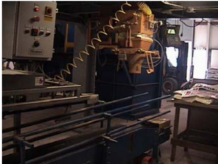
Foto 4 Maquina empacadora de pellets de madera en envases para la distribución a pequeños consumidores (secuencia fotográfica).
