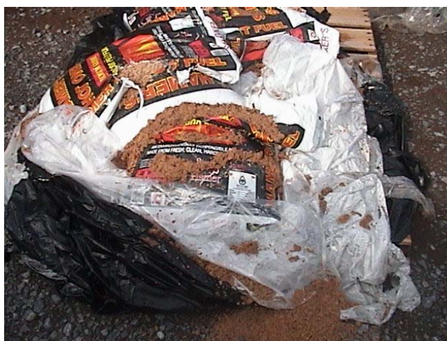
Foto 9. Ejemplo de pellets dañados por efecto de la humedad.
