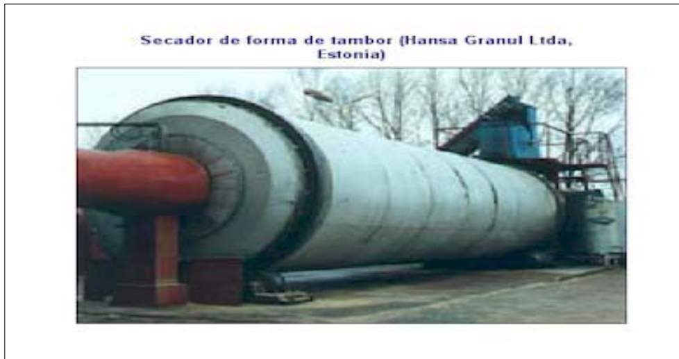
Foto 5. Secador del tipo Tambor Rotatorio.
