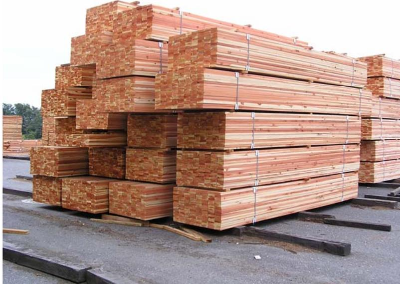
Figura 3.19 Madera aserrada en PALCO, calidad Construction Common
