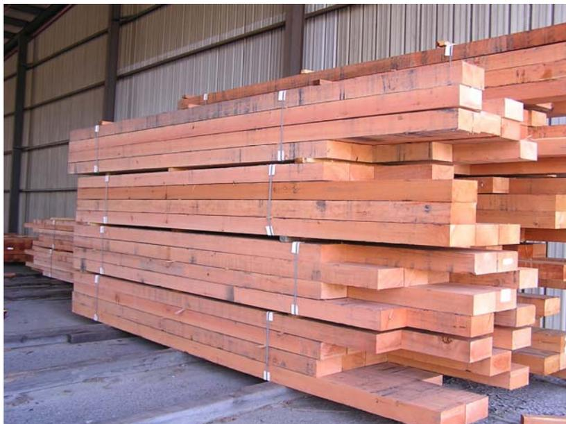
Figura 3.20 Madera aserrada en PALCO, calidad Construction Heart
