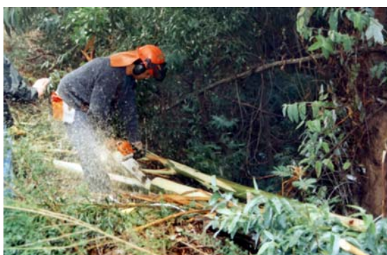
Figura 7: Obtención de rodela con motosierra.
