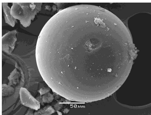
Figura 45: Imagen obtenida mediante SEM de a una MC sintetizada con TOPO como extractante.
