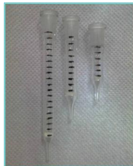
Figura 6. Columnas grande, mediana y pequeña con sus respectivas subdivisiones.
