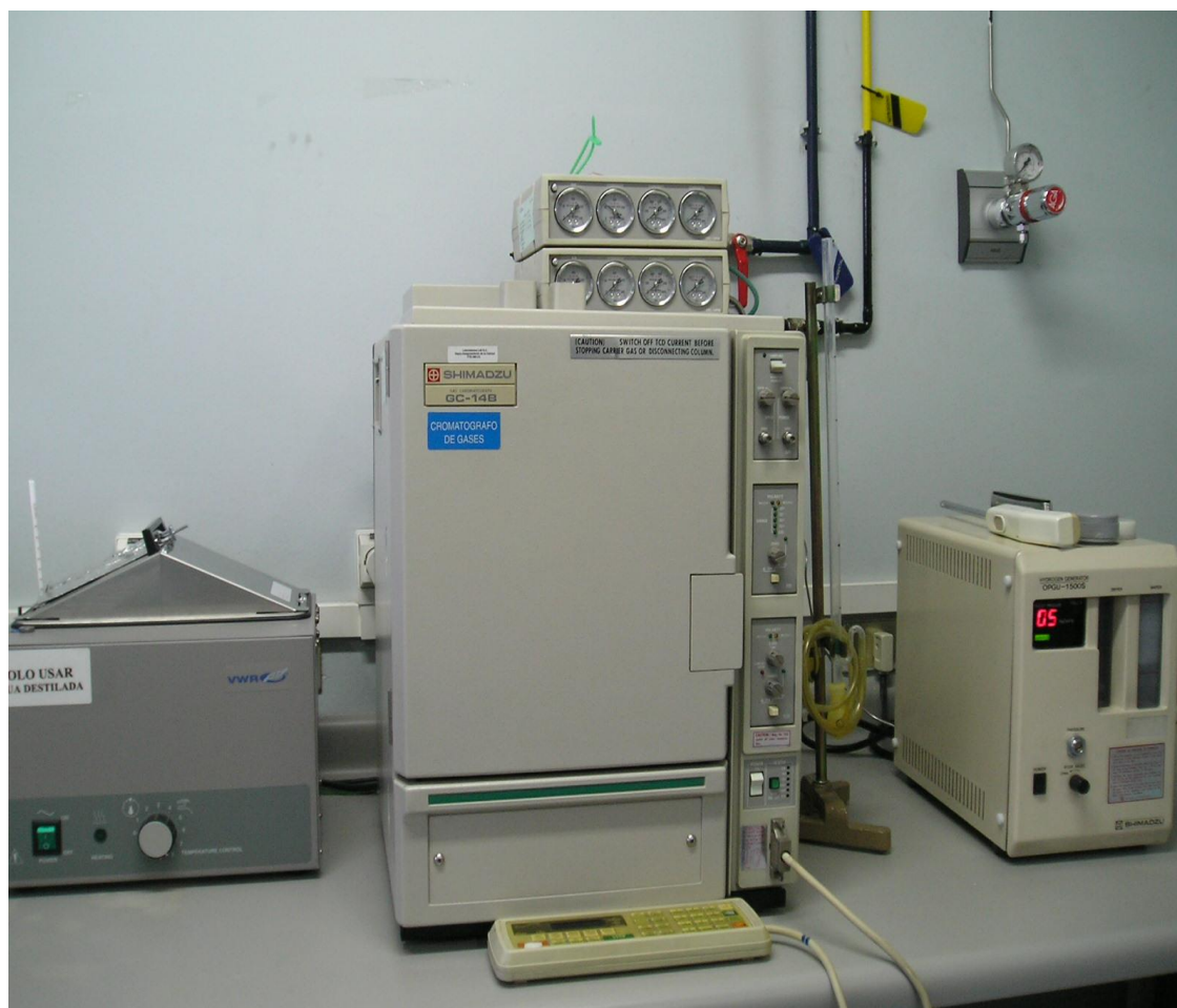
Figura N° 8, Fotografía del cromatógrafo de gases Shimadzu GC-14B.
