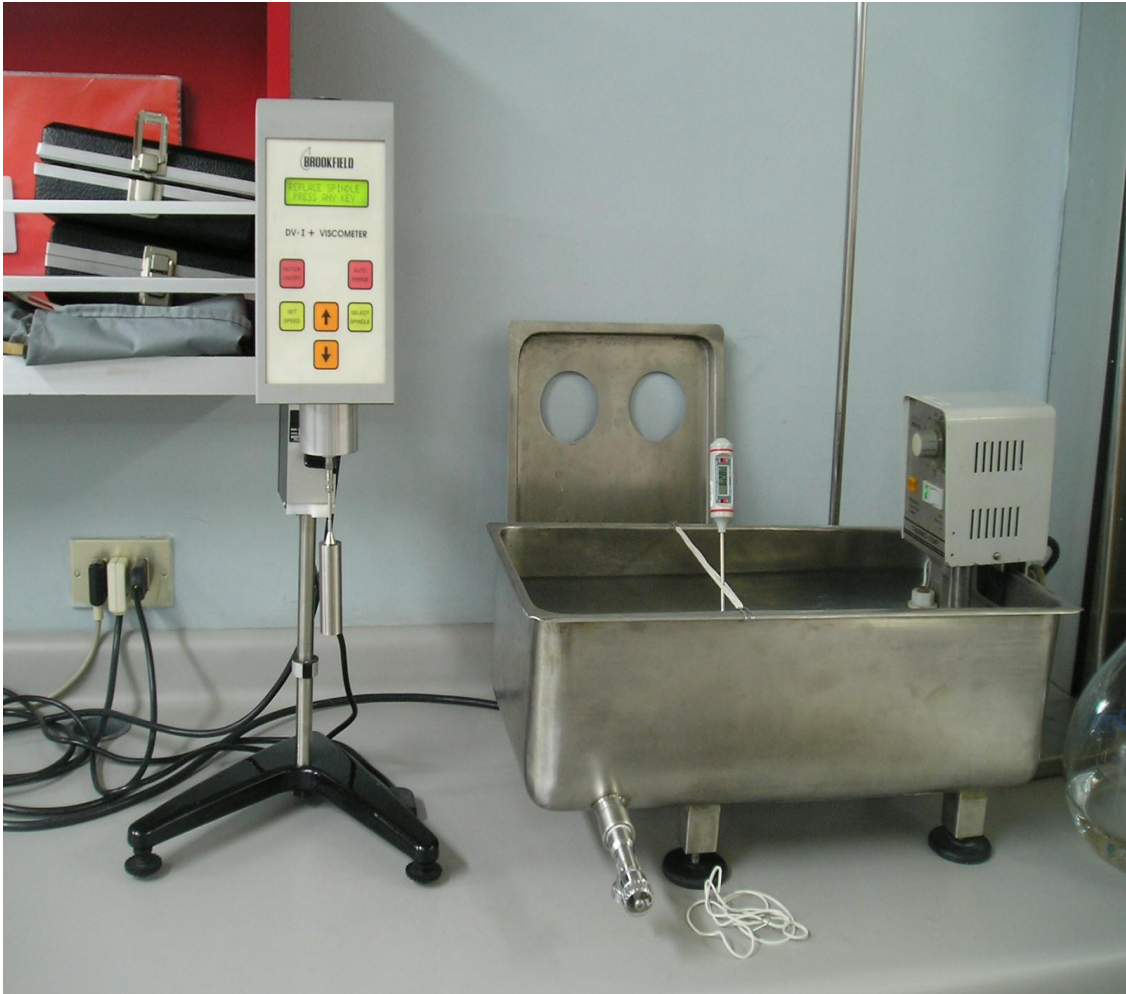
ANEXO N° 3: Figura N° 6, Fotografía del viscosímetro digital Brookfield LV DVI+.
