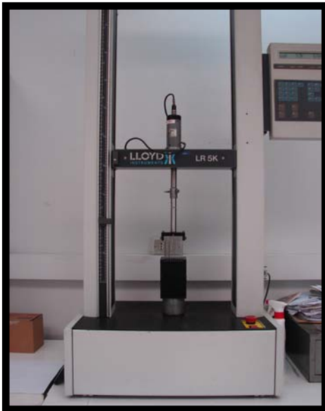
Figura 3: Máquina universal de ensayo de materiales Lloyd Instruments Limited modelo LR5K y celda kramer.
