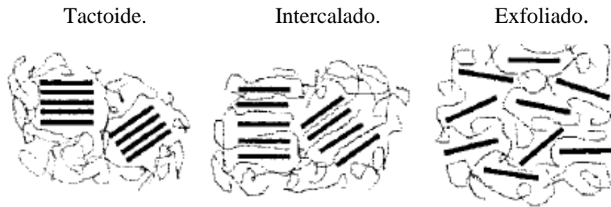
Figura 8. Diferentes estados de dispersión de las nanoláminas de arcillas en un nanocompósito de matriz polimérica.
