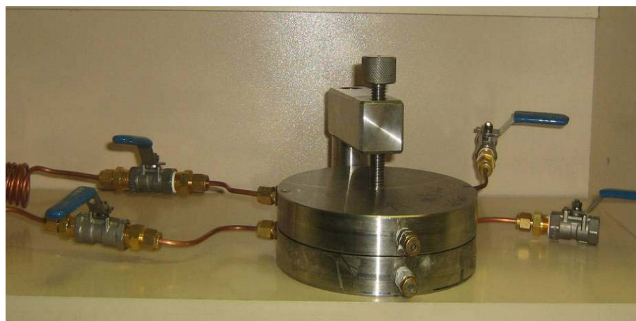
Fig 10. Fotografía de la celda de permeabilidad utilizada en el análisis de permeabilidad a naftaleno.
