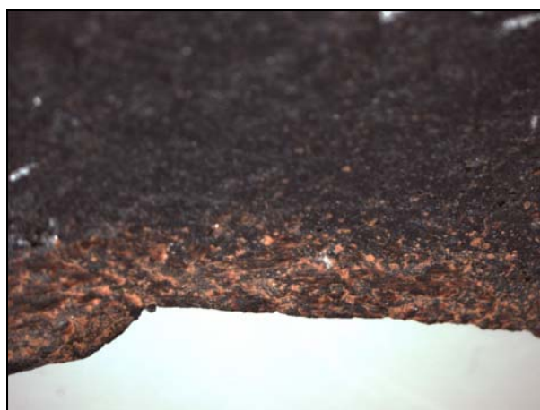
Foto 10. Pieza Nº 25, residuos vistos bajo lupa binocular (67X)
