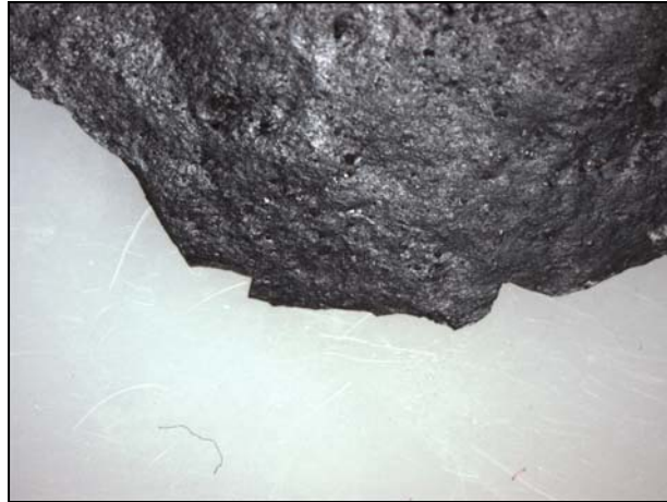
Foto 18. Pieza Nº 12 vista desde lupa binocular. Se observan huellas en forma triangular
