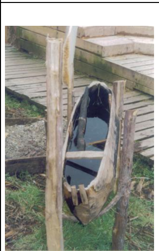
Replica de una canoa construida por Francisco Arroyo Edén en febrero de 2004. Con una motosierra le dio forma a un tronco de un metro a metro y medio de largo que comenzó a ahuecarlo hasta llegar a un nivel de corte final para luego echar brasas al interior con haciendo una especie de sellamiento.
