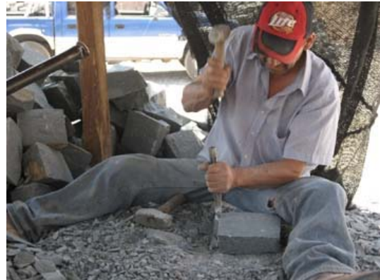
Cantero cuadrando un adoquín con el cesto (2007).
