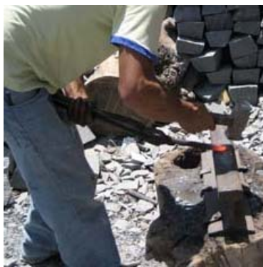
Minero arreglando sus herramientas a golpes después de retirarlas de la fragua (2007).
