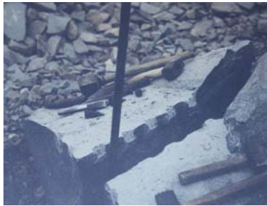
Garcés, M. 1999. Roca cortada a través del sistema de golpe de cuñas.
