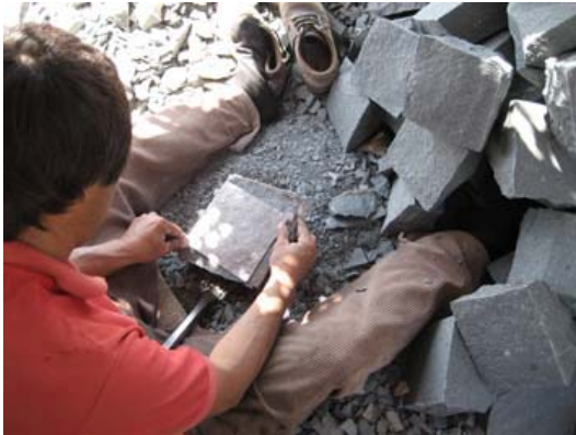
Cantero marcando las dimensiones del adoquín en la piedra con una plantilla de metal (2007).
