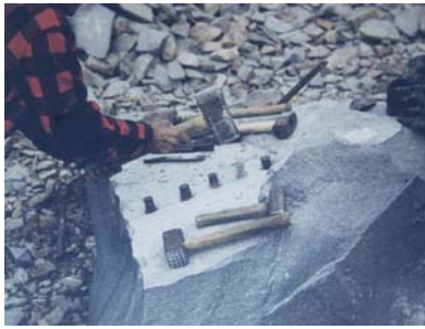
Garcés, M. 1999. Cuñas instaladas para cortar una roca.
