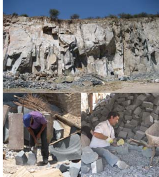
Canteras artesanales orientadas a la producción de adoquines en la Comuna de Colina (Chile).
