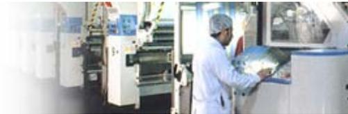
Para la **producción** de los **cilindros** de impresión por huecograbado y **clisés** de impresión por flexografía, que son las "matrices" que llevan el diseño y entregarán los colores al material de impresión, Edelpa cuenta con cinco equipos grabadores electromecánicos de cilindros de tipo film-less, y un equipo de grabado de fotopolímeros para clisés.
