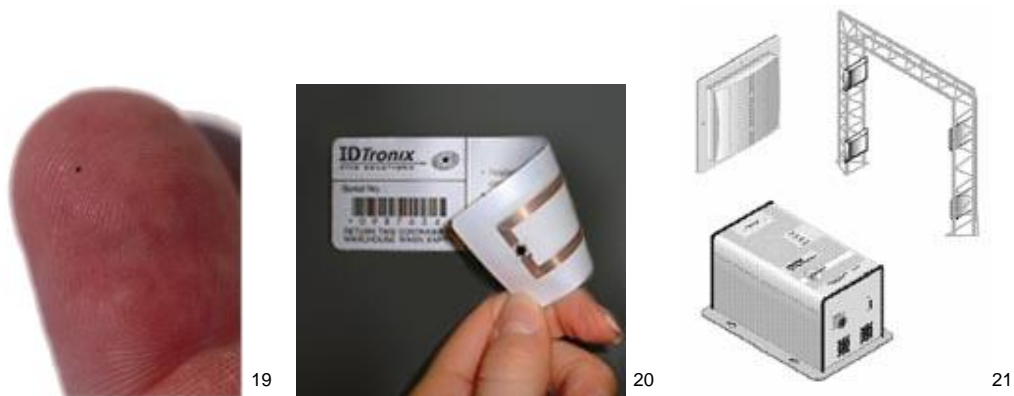
Figura N° 7 Elementos componen un sistema de RFID
