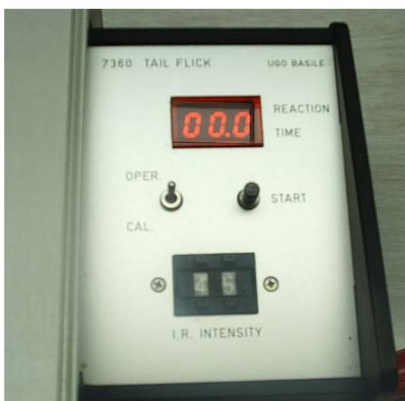
**Foto 3.** Cronómetro de registro de latencia de respuesta.
