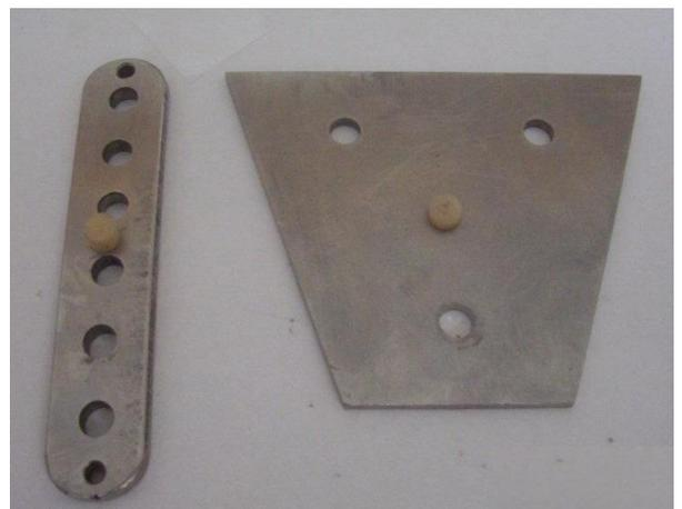
**Probeteros metálicos de 4mm. Y 3mm. De espesor**
