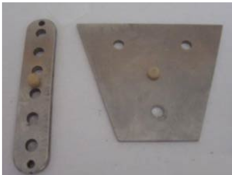
Fotografía 2 Probeteros metálicos de 4mm. Y 3mm. De espesor
