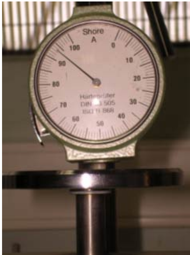
Fotografía 10 Identación sobre superficie de probeta
