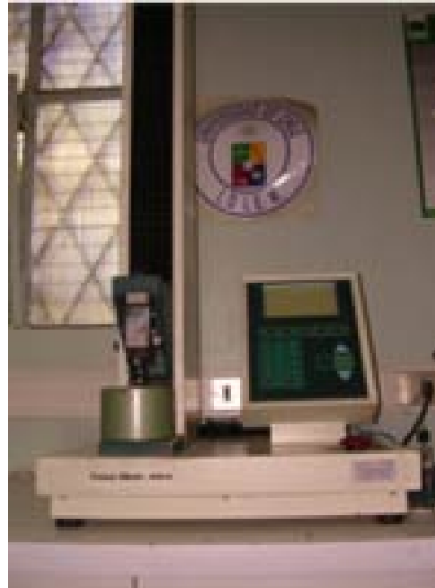
Fotografía 7 Máquina de ensayo universal Instron
