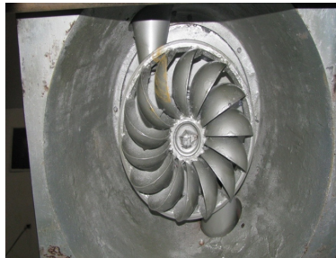
Figura 3.2: Turbina tipo Turgo con inyectores. Microhidráulica Inteligente. [8]
