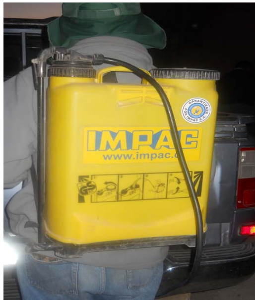
Figura 4. Bomba de espalda (Impac 16, Impac).
