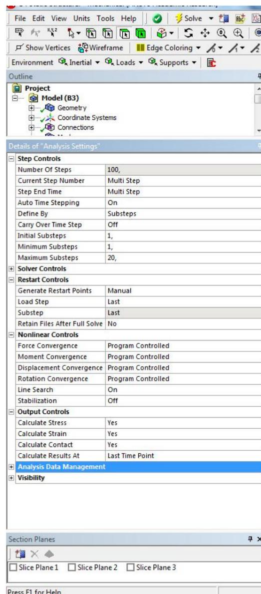
Figura 3.32: Seteo general del Solver para el problema de contacto no lineal
