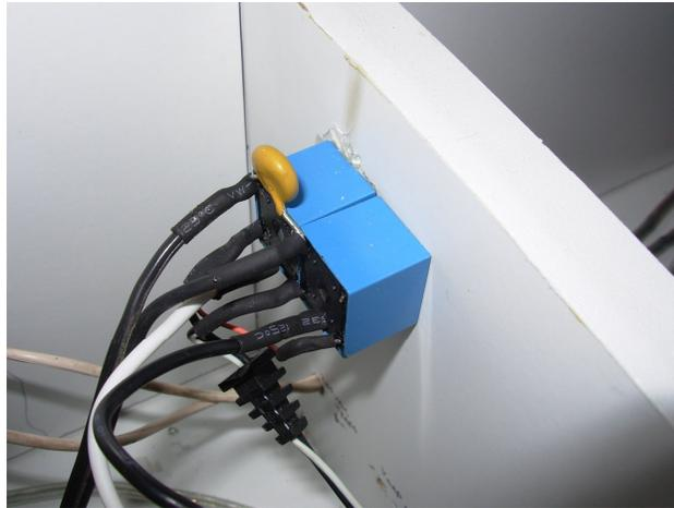
Figura 3.13: Relés 10A / 220VAC y 12VDC
