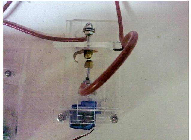
Figuras 3.20: Interruptor de descarga rápida: vista lateral (en posición de corte de seguridad), vista superior (en posición de corte de seguridad)
