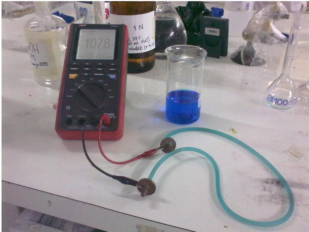
Figura 3.17: Resistencia electrolítica tubular con solución de 2 M de sulfato de cobre y una resistividad de 10 K $\Omega$  aprox.
