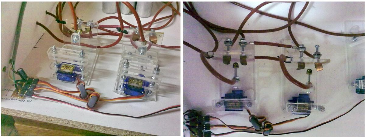
Figuras 3.19: Interruptores de descarga: vista lateral (apagado), vista superior (apagado)
