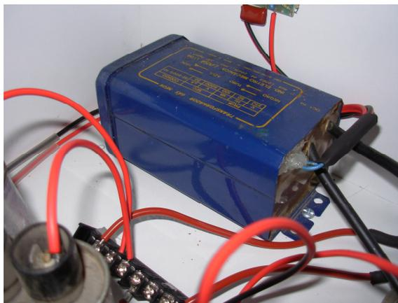
Figura 3.10: Transformador de alto voltaje 15 kVAC / 30 mA / 450 VA
