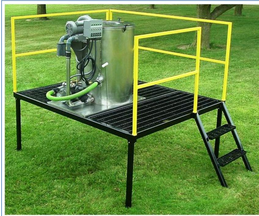
Ilustración 3. Ejemplo de máquina productora de té de compost que funciona mediante colado a alta velocidad. Fuente: <http://www.rittenhouse.ca/asp/Product.asp?PG=1179>
