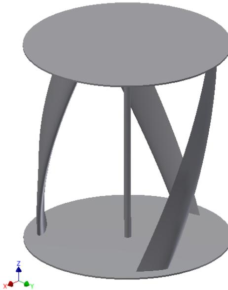
Figura 3.24: Estructura de la turbina modificada de 3 álabes
