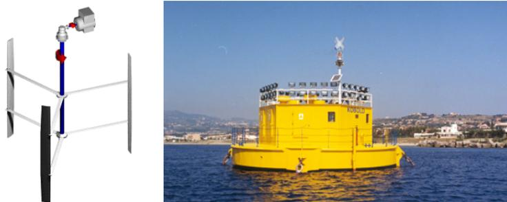
Figura 2.11: Turbina Kobold. Originales del estudio del laboratorio LEGI [5].
