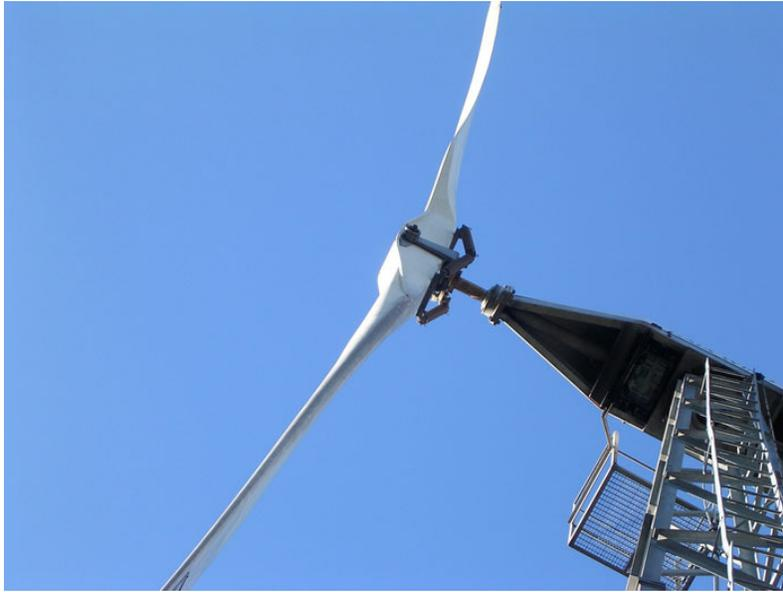
**Figura 2.21: Turbina de dos palas con control por pérdida aerodinámica pasiva.**
