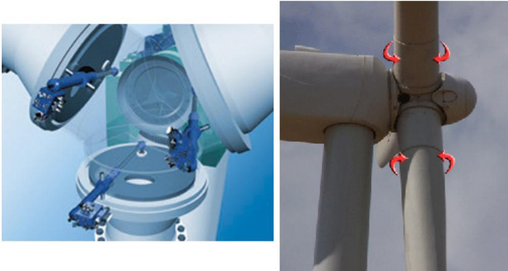
**Figura 2.20: Control de ángulo de paso.**
