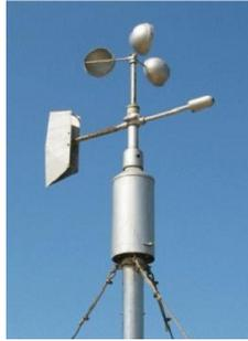
**Figura 2.12: Anemómetro de rotación.**
