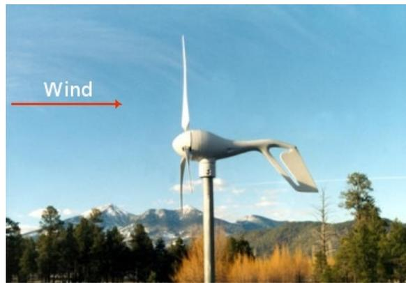
Figura 2.4: Hélice con rotor a barlovento (*upwind*).
