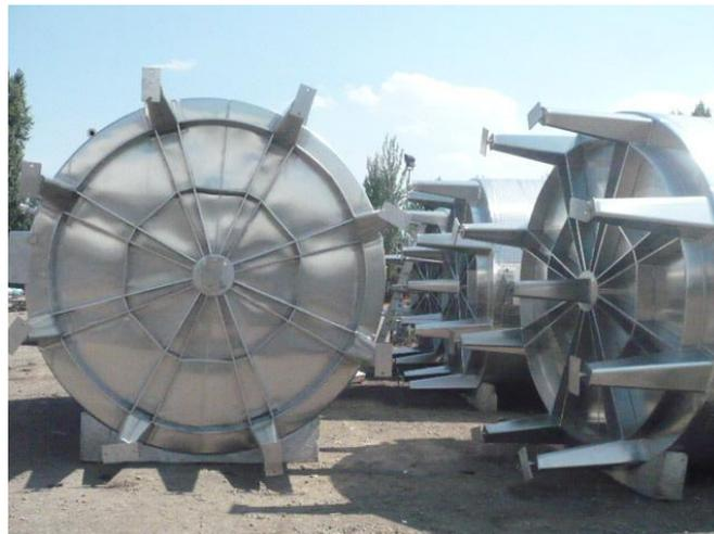
Figura 3.1-4: Estanque Montado Sobre Patas con Sistema de Rigidización de Fondo
