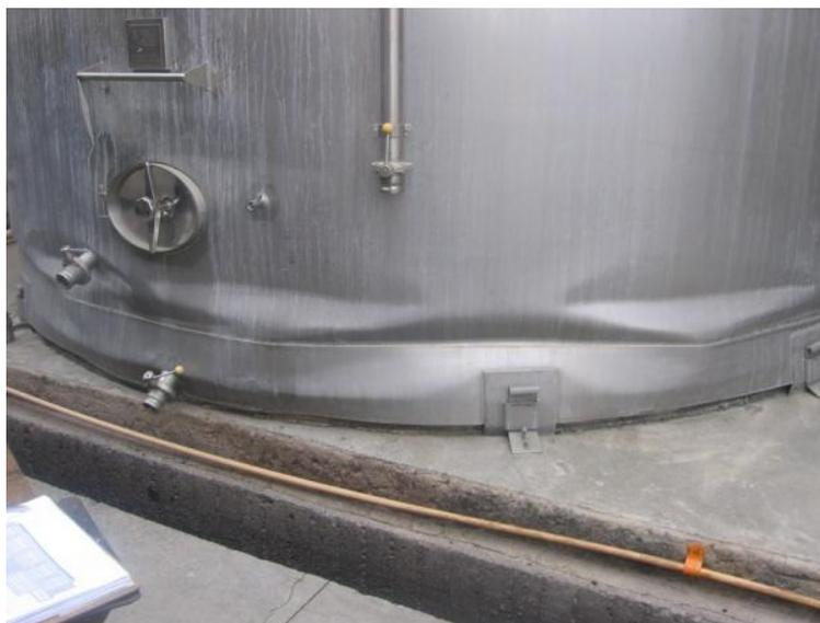
Figura 3.3-5: Distribución ineficiente de anclajes
