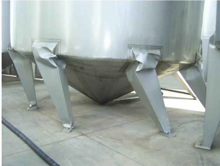
Figura 3.1-9: Colapso lateral de patas
