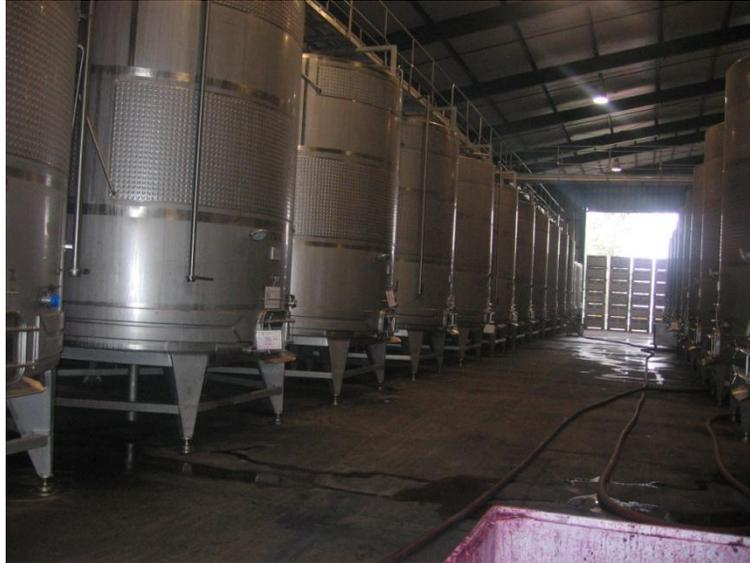
Figura 3.3-6: Estanques con patas arriostradas.
