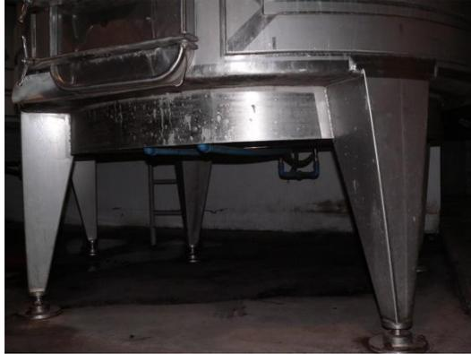
Figura 3.1-2: Estanque Montado Sobre Patas con Fondo Plano
