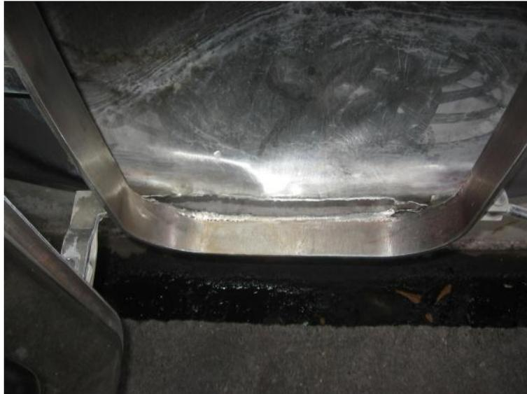
Figura 3.2-28: Falla en soldadura inferior de portalón
