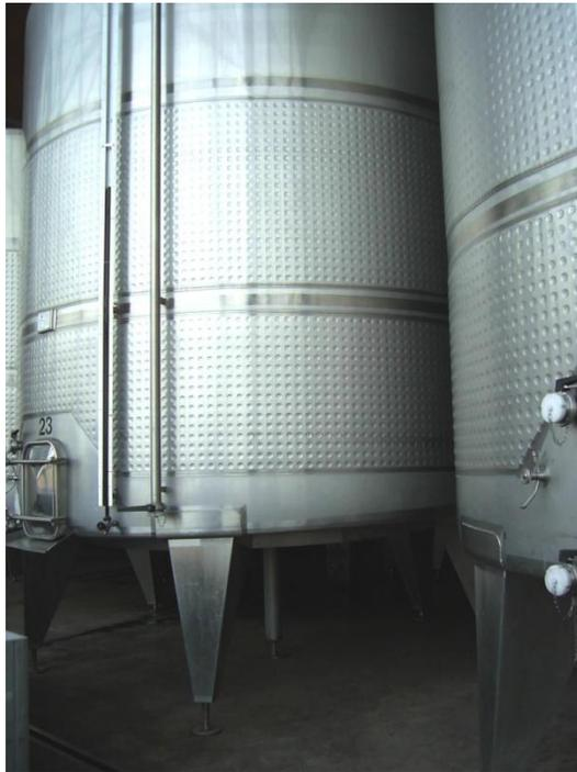
Figura 3.1-6: Estanque con Patas Soldadas al Fondo y al Manto
