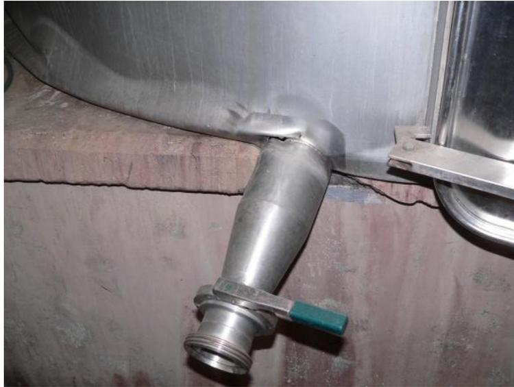
Figura 3.2-29: Falla en soldadura de válvula
