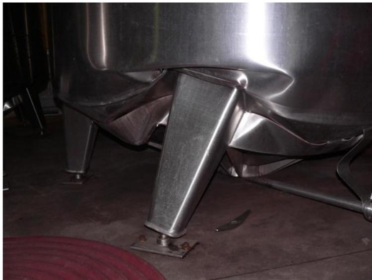
Figura 3.1-17: Estanque afectado por punzonamiento
