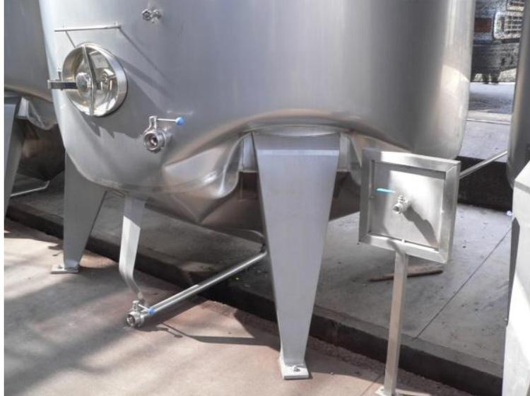
Figura 3.1-16: Estanque afectado por punzonamiento
