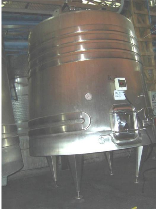
Figura 3.1-5: Estanque con Patas Soldadas al Fondo
