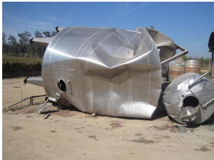
Figura 3.1-19: Colapso por vaciado rápido
