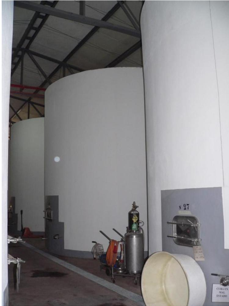
Figura 3.2-2: Estanques de apoyo continuo (hormigón armado)
