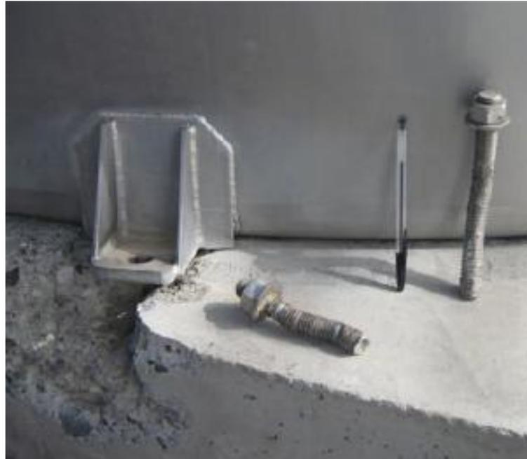
Figura 3.2-19: Rotura lateral de fundación
