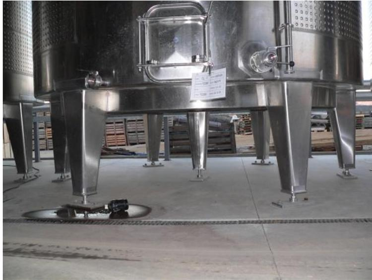
Figura 3.1-7: Estanque con Pata Central
