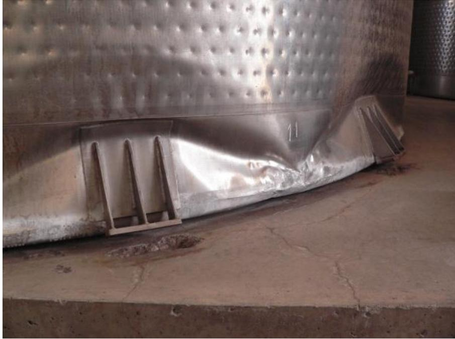
Figura 3.2-15: Largo insuficiente de pernos
