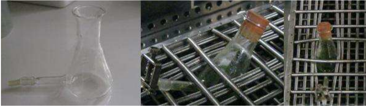
Imagen D-5. Matraces Erlenmeyer-modificados. (a) Matraz antes de iniciar la fermentación (estrategia SSF y/o SHF). (b) Vista lateral del matraz durante fermentación (estrategia SSF y/o SHF). (c) Vista superior del matraz durante fermentación (estrategia SSF y/o SHF).
