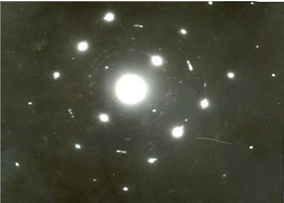
Figura 3 (Fig. 4.2): Observaciones TEM de aleación x = 7\%at a 600^{\circ}C / 3h.
