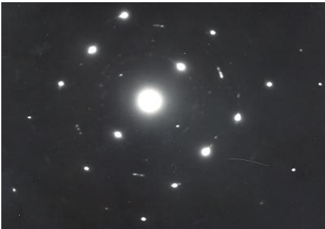
Figura 4.2: Observaciones TEM de aleación x = 7\%at a 600^{\circ}C / 3h . (a) Imagen de Campo Claro y (b) Diagrama de Difracción
