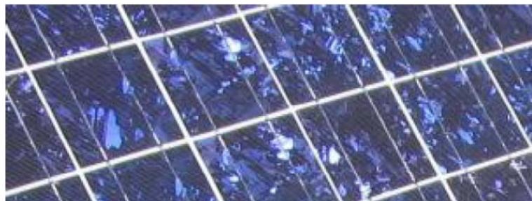
Figura 2.10: Celda de Silicio Policristalino.
