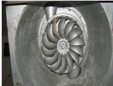
Figura 3.2: Turbina tipo Turgo con inyectores. *Microhidráulica Inteligente.*[8]
