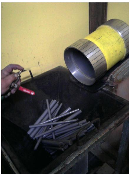
Figura 4.8. Descarga de Molino de 2,3 Kilogramos de capacidad.
