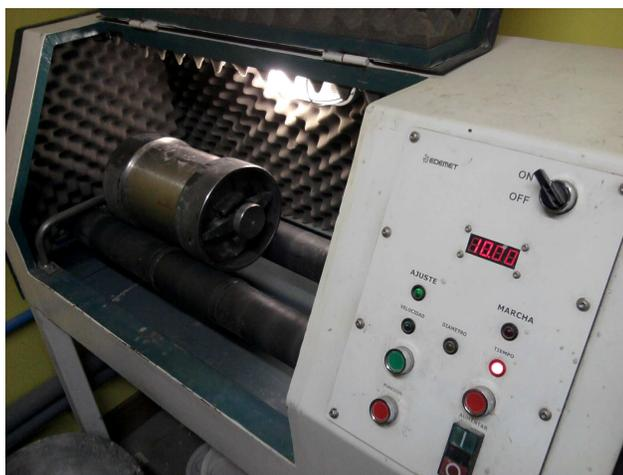
Figura 4.6. Molino de 2,3 Kilogramos de capacidad.
