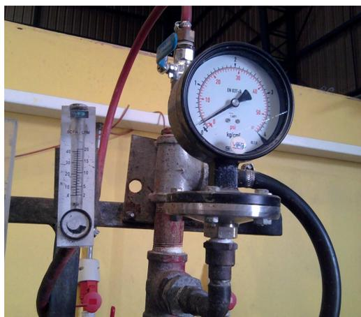
Figura 4.12. Rotámetro de aire comprimido y manómetro.
