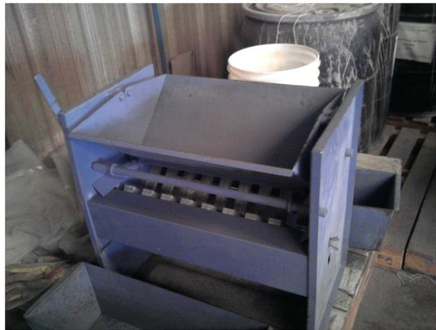
Figura 4.5. Cuarteador tipo *riffle*.
