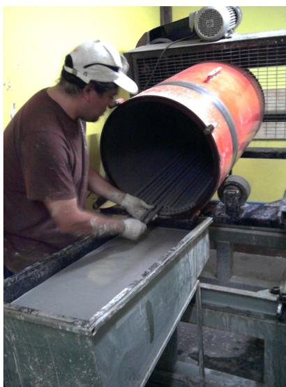
Figura 4.7. Molino de 20 Kilogramos siendo descargado.
