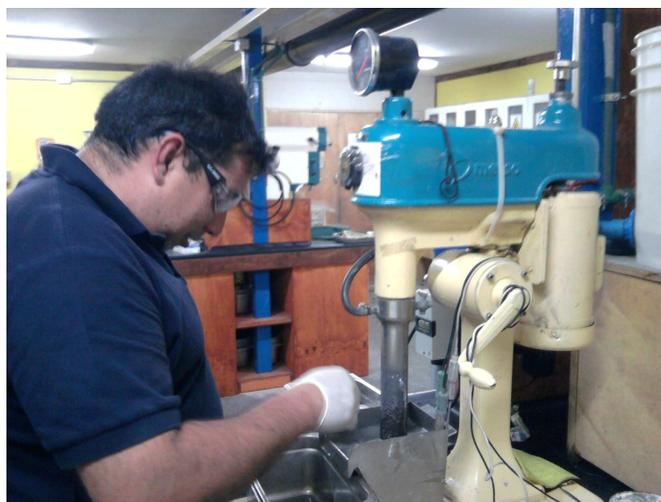
Figura 4.10. Flotación en celda mecánica.
