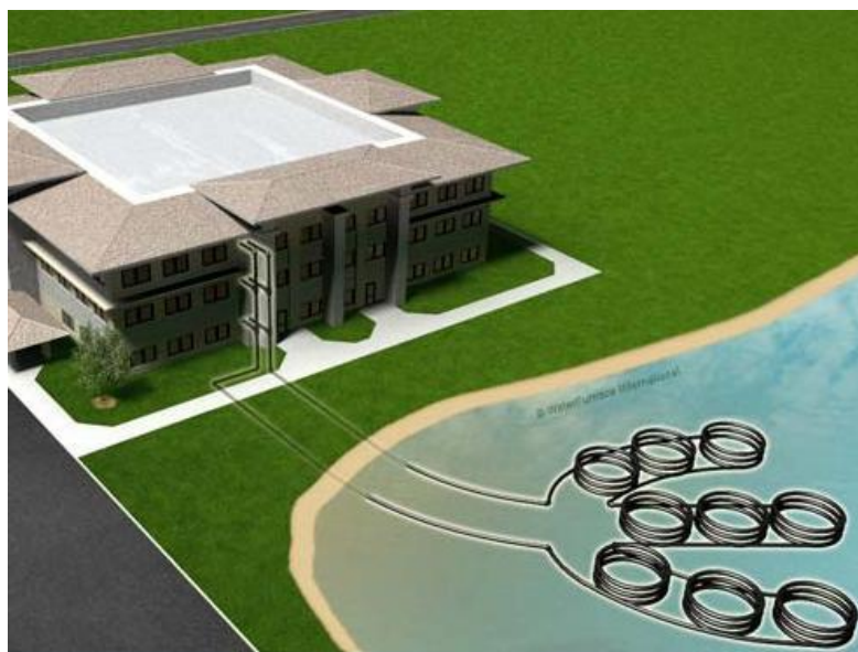
Figura 5.12: Instalación de cañería en espiral en laguna. Fuente www.waterfurnace.com
